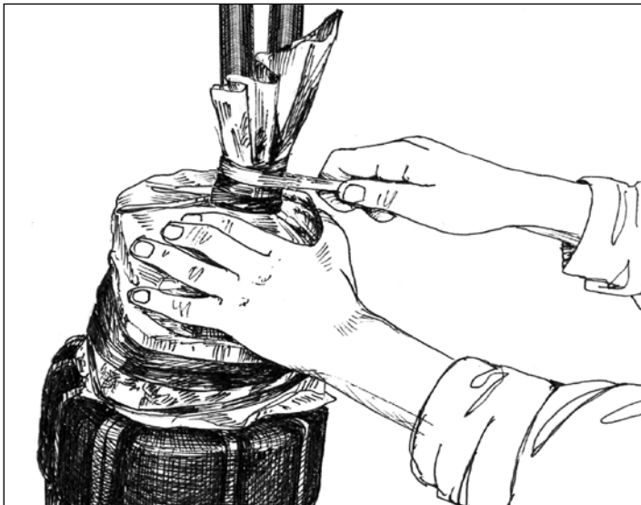
Рис. 3.6. Обмотка полиэтиленового рукава на кабелях ПВХ лентой
